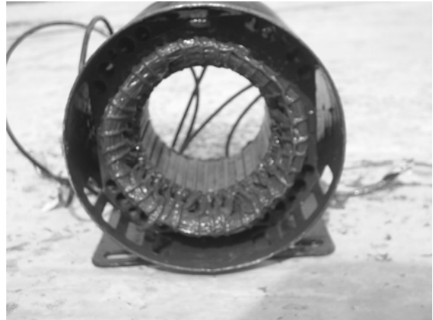
Figura B. 18 Devanados del estator del segundo prototipo
